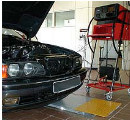
Slika 1: Fotografija pokretnog uređaja za mjerenje ispušnih plinova motornih vozila oznake CET 2200 C s kompletnom opremom
